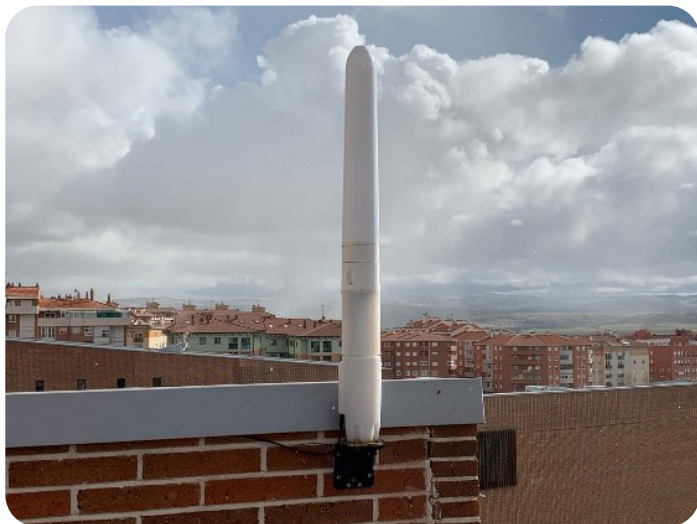
Сл. 65. Ветерната турбина без крила Vortex Bladeless
