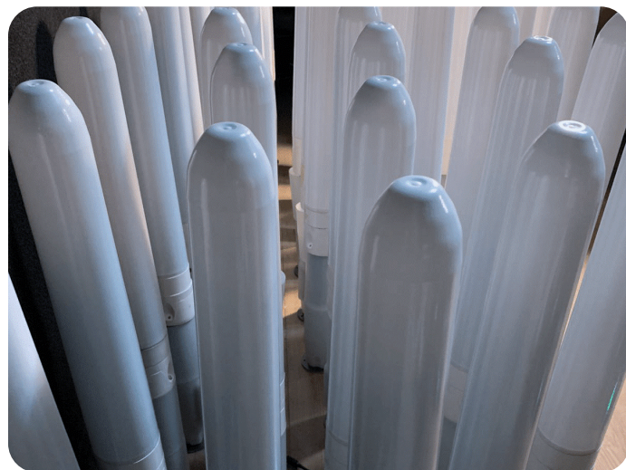
Сл. 65. Ветерната турбина без крила Vortex Bladeless
