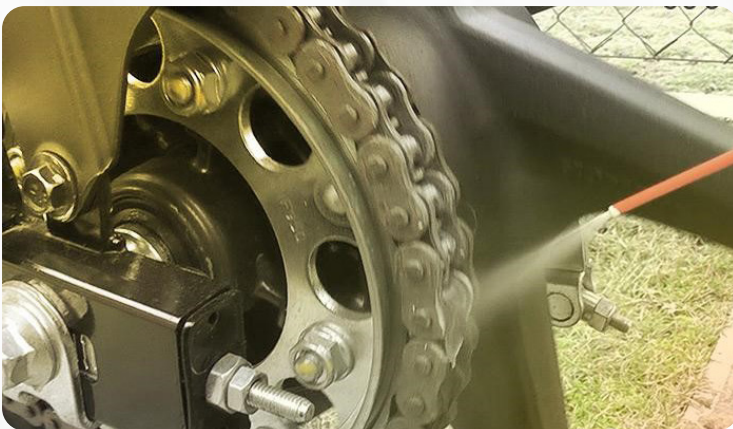
Lubrificazione della catena
